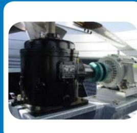
Система зубчатой передачи с сопряженным мотором
